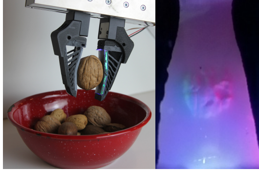
图 1: 左边，GelSight Baby Fin Ray 抓住了一个核桃；右边是相应的原始触觉图像 [1]。
