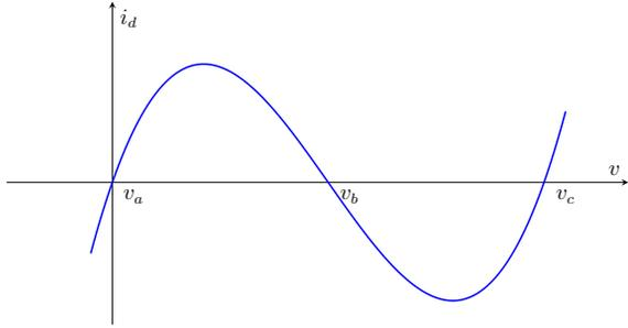
Fig. 3. N 形非线性电阻的电流-电压曲线。
