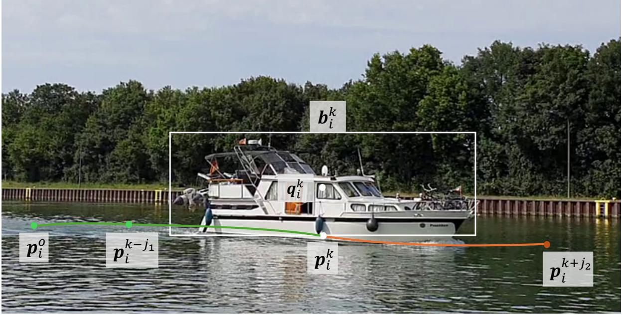
图 1: 用于检测、跟踪和预测的参数可视化，以一艘向前移动的船只为例。边界框  $\mathbf{b}_i^k$ ，框中心  $\mathbf{q}_i^k$ ，用于跟踪的当前锚点  $\mathbf{p}_i^k$ ，过去帧的轨迹（绿色）和预测轨迹（橙色），以及当前帧索引  $k$  和对象索引  $i$  对应的采样时间。值  $j_1 > 0$  和  $j_2 > 0$  用于说明时间点。
