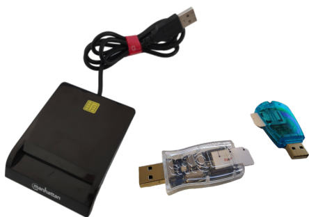
图 2: 低成本的 SIM 卡读取设备（基于 PC/SC 或串行接口），这些设备受到 MobileAtlas 基础 SIM 提供程序的支持。
